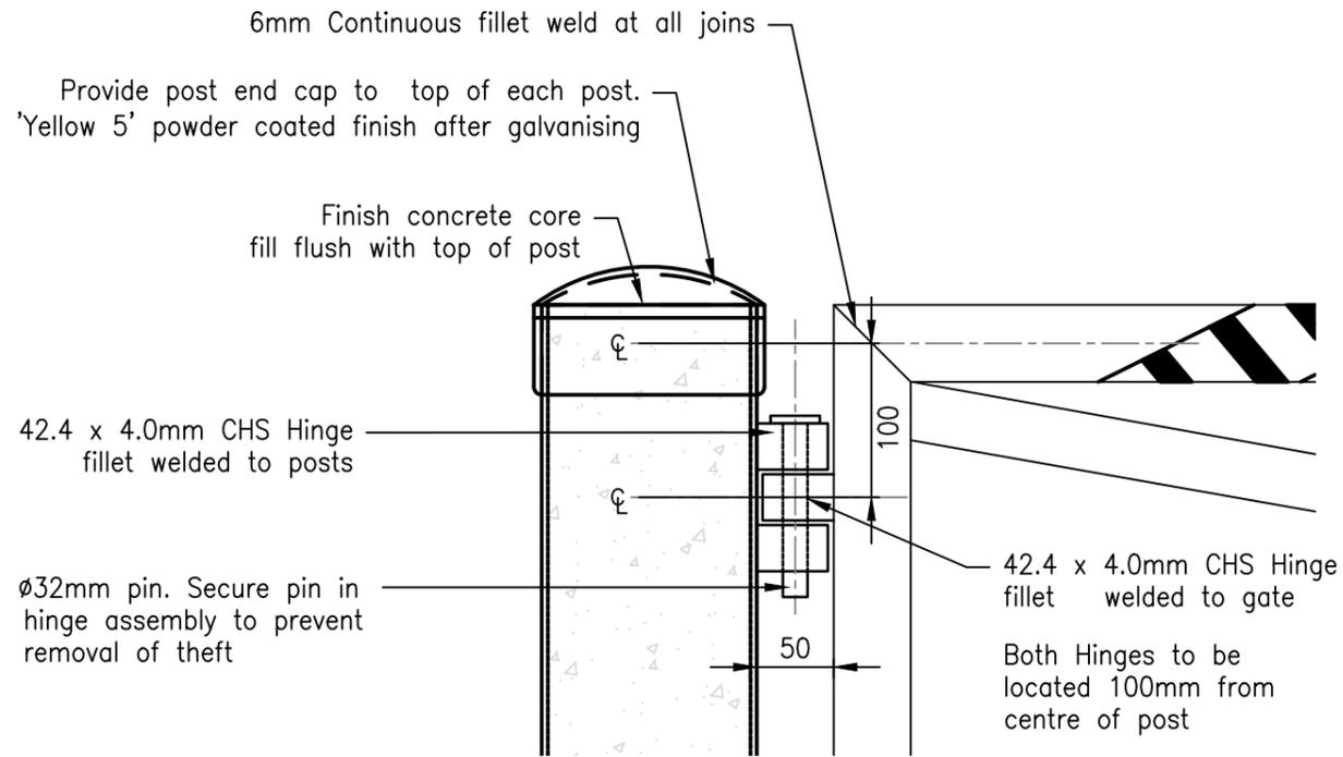
**STEEL LOCK GATE HINGE DETAIL**
